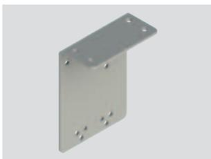
Plaque de fixation en métal, prévue pour fixer les interrupteurs avec actionnement à câble au plafond. La plaque est équipée de trous appropriés pour la fixation des interrupteurs des séries FD, FL, FC, FP, FR, FM, FX, FK. Elle est fournie sans vis.
