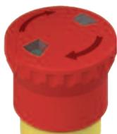
Les versions des boutons d'arrêt d'urgence à déblocage par traction ou par rotation peuvent être équipées de signalisation visuelle de l'état par un indicateur mécanique. Le changement d'état est indiqué par le passage de la couleur verte des fenêtres de signalisation quand le bouton est au repos à la couleur rouge quand il est actionné.
