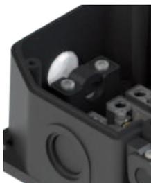
À l'intérieur du boîtier, juste après l'entrée des câbles, un dispositif serre-câbles est présent dans l'axe de l'ouverture. Idéal pour maintenir le câble électrique en position, il empêche que d'éventuels mouvements ou tractions répétés n'atteignent les connexions électriques du bloc de contact. Réversible, il peut serrer des câbles de petite et grande dimension.
