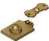
Les blocs de contact peuvent être fournis avec les contacts électriques en argent ayant une dorure superficielle avec une épaisseur totale d'or égale à un micron. Ce type de traitement peut être utile en présence de milieux agressifs envers l'argent et en cas de charges électriques très petites, ayant des basses tensions et de faibles courants d'alimentation.
