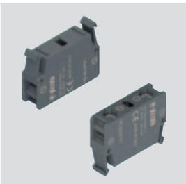
Blocs de connexion de dimensions identiques aux blocs de contact, mais dépourvus de contacts électriques. Équipés de deux bornes séparées électriquement, ils permettent d'installer le disque lumineux de la série VE DL sans bornes ni sertissages supplémentaires.
