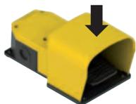
Les interrupteurs à pédale de la série PX sont dotés d'un capot particulier à profil renforcé. Cette solution permet au capot de supporter des charges statiques allant jusqu'à 800 N sans casse, et donc de résister au piétinement. Pour les environnements particulièrement exigeants, le capot peut être fourni dans un matériau renforcé à la fibre de verre pour résister également aux sollicitations de chocs dynamiques.
