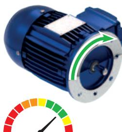
Los módulos CS AM2• permiten controlar la velocidad de rotación del motor mediante la medición de la frecuencia de las fases del mismo. Las salidas de seguridad se desactivan cuando la frecuencia medida se encuentra fuera del rango configurado.
