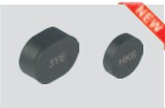
Les cache-vis codés sont encliquetés dans les fentes des vis de fixation, rendant l'accès aux vis impossible, ce qui empêche tout démontage de l'interrupteur ou de l'actionneur. Ils ne peuvent être retirés qu'en les détruisant, si bien que toute tentative de manipulation sera immédiatement évidente.
